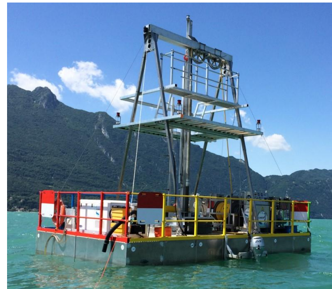
Barge CLIMCOR modulable de 7m x 4m -Armement HYDRO (hydraulique à eau)
