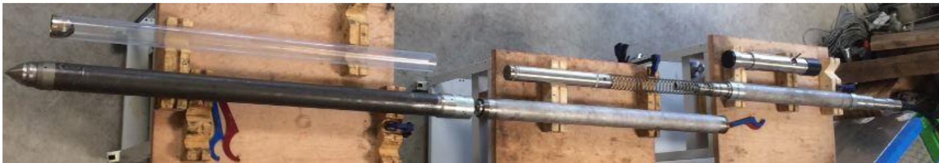
CLH-112 corer; assemblage complet avec marteau et vérin
